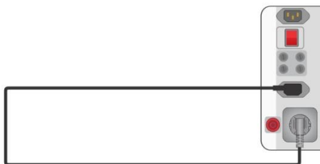
Figure 6.16: Continuity MS PE – IEC PE
