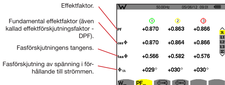
Figur 98: Enheterna associerade till effektskärmen i 3L
