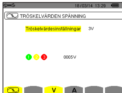
Figur 29: Skärm för spänningsgränsvärden i transientlägesmenyn
