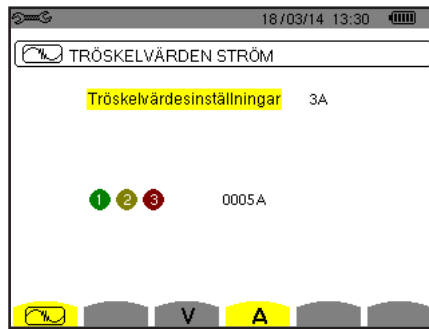
Figur 30: Skärm för strömgränsvärden i transientlägesmenyn
