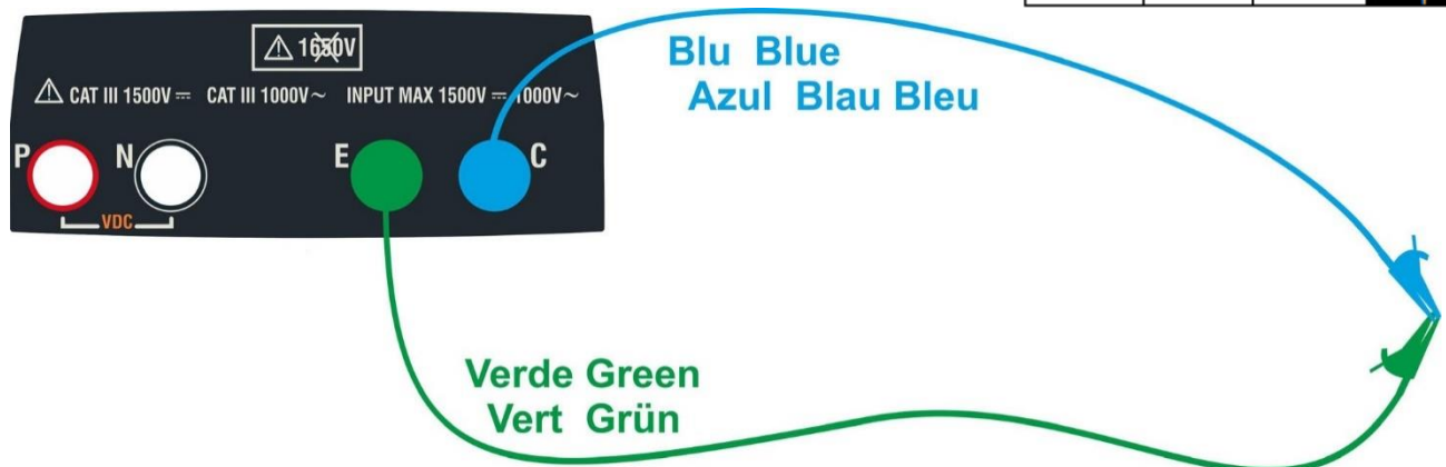
Fig. 4: Kompensering av testledningarnas resistans
