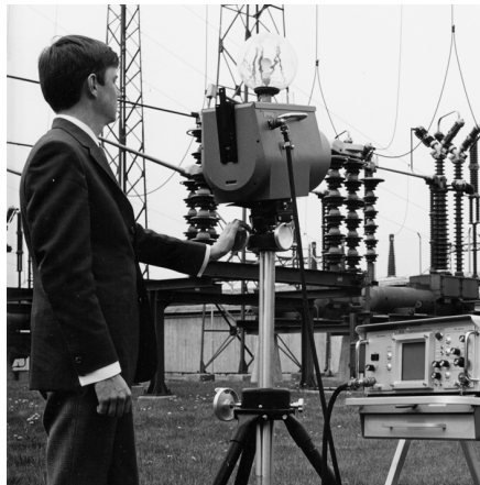
1969: Thermovision model 661. Kameraet vejede ca. 25 kg, oscilloskopet 20 kg og stativet 15 kg. Brugeren skulle også bruge et 220 VAC-generatorsæt og en 10 l beholder med flydende kvælstof. Til venstre for oscilloskopet ses Polaroid-udstyret (6 kg).
